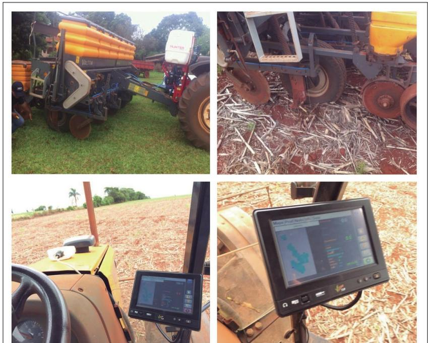
**Figura 13.** Equipamento para a aplicação localizada de insumos em sulcos de sementeira provido de controladores eletrônicos e computador de bordo.
